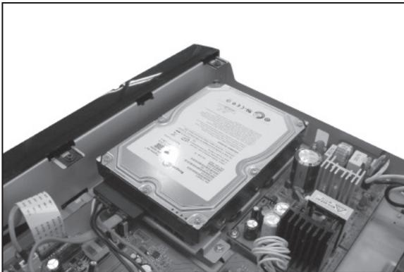
Ansicht mit eingebauter 3.5" HDD.
